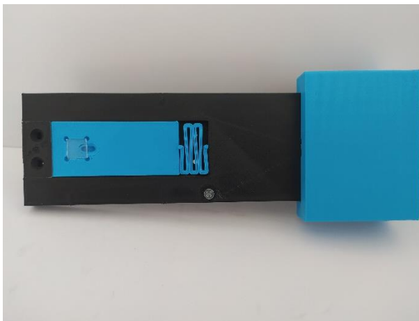
Rys.9. Stoliczek pomiarowy do mikroskopu AFM
