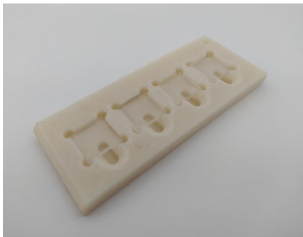
Rys.8 Stoliczek pomiarowy do spektrometru ramanowskiego
